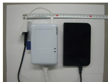
小型サーバ(SheevaPlug)& キャプチャ用HDD
