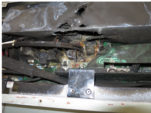
図 1.2: (左) UPS の内部, (右) 焼けた回路基板
