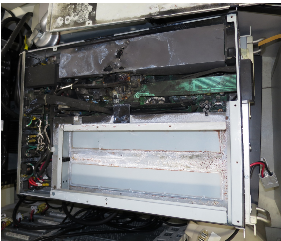
図 1.2: (左) UPS の内部, (右) 焼けた回路基板
