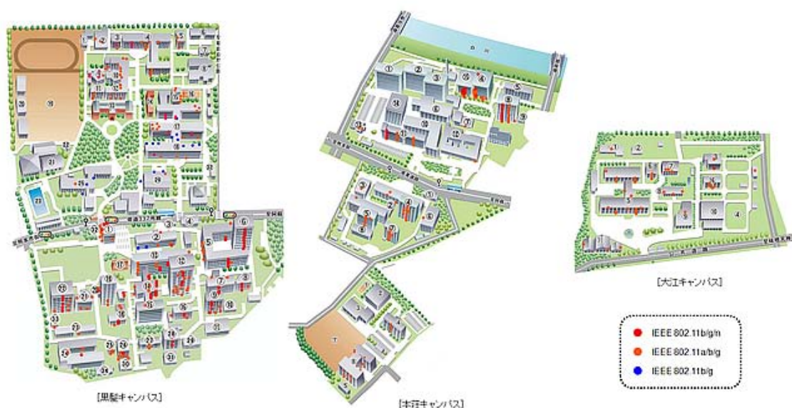
図2 全学無線LANシステム無線基地局配置図
