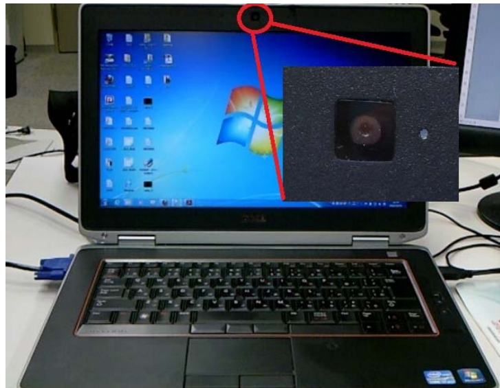
図5 ディスプレイ上部の USB カメラから練習者の顔画像を取得
